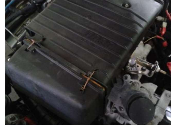
Tampa do filtro de ar mal fixada.
