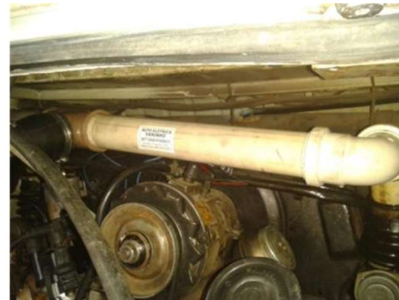
Tubulação de admissão de ar inadequada.
