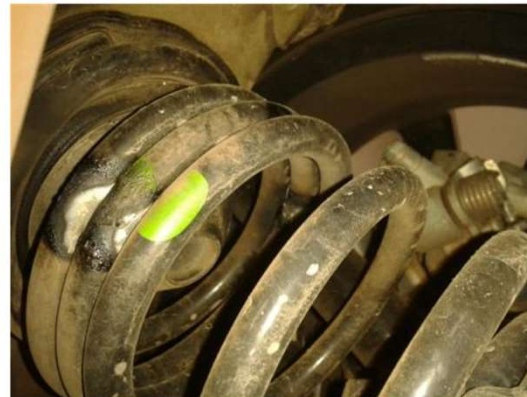
Mola com deformação permanente a quente, utilizando maçarico.
