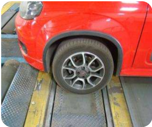
Bancada de suspensão – método Eusama
