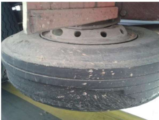
Banda de rodagem desprendida.
