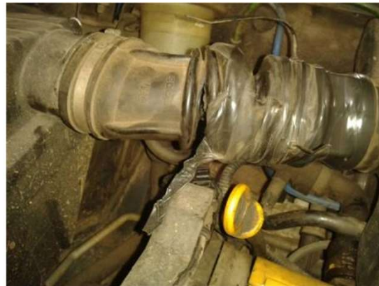
Tubulação de admissão de ar rompida e com reparo inadequado.
