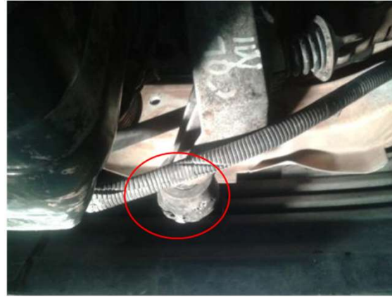
Suporte do motor sem fixação.
