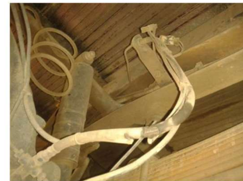
Conduíte de freio danificado e com vazamento.
