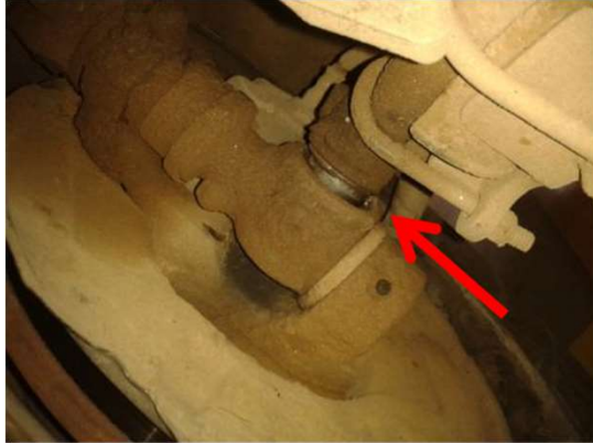
Manga de eixo com folgas excessivas.
