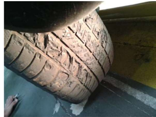
Banda de rodagem com quebras.
