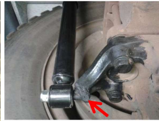
Fixação do amortecedor inadequada, sobre elemento soldado.
