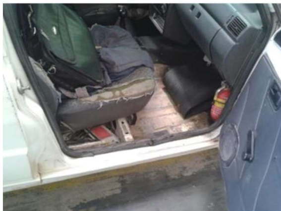
Assoalho com corrosões excessivas e número do chassi oxidado.
