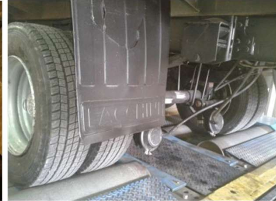
Eixo com montagem incorreta: nota-se as cuícas baixas.
