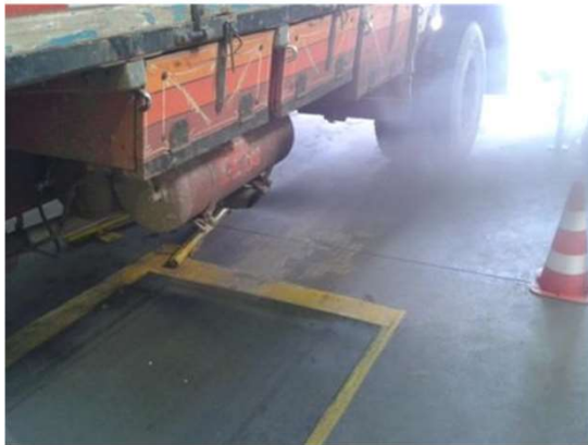
Emissão excessiva de fumaça preta.
