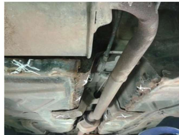
Assoalho com reparos inadequados e descravamento de chapas.
