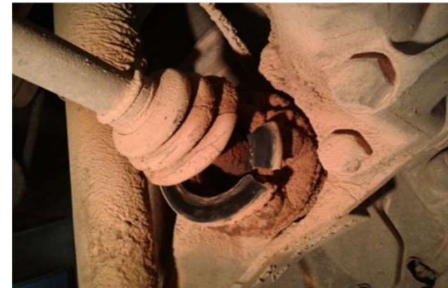
Coifa da junta homocinética rompida, sem lubrificação.
