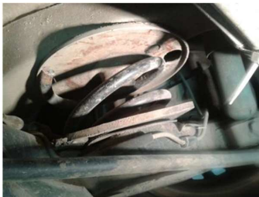
mola traseira cortada, com intenção de rebaixamento.
