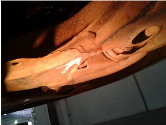
Trinca no agregado da suspensão.
