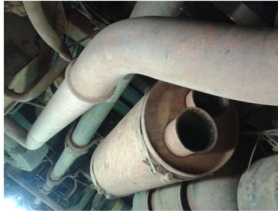
Escapamento modificado: silencioso isolado.
