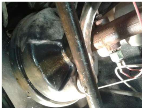
Vazamento de fluido de freio no cilindro mestre.
