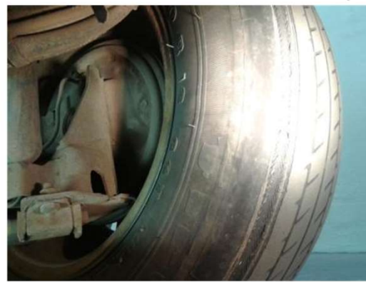
Pneu excessivamente gasto, mostrando os cordonéis.
