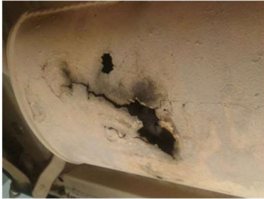
Corrosão excessiva no silencioso.
