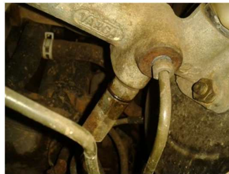
Vazamento de válvula equalizadora de pressão.
