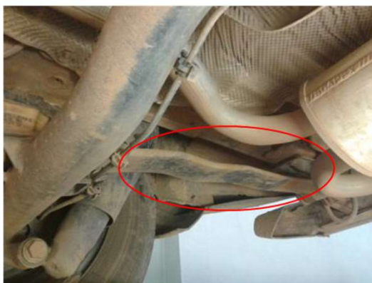
Deformação permanente da mola traseira.
