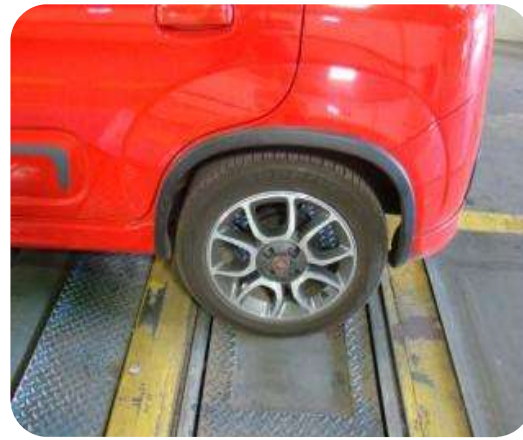
Bancada de suspensão – método Eusama
