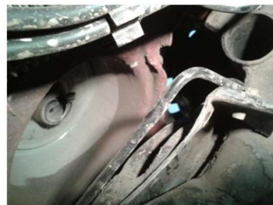
Conjunto de suspensão sem a mola.
