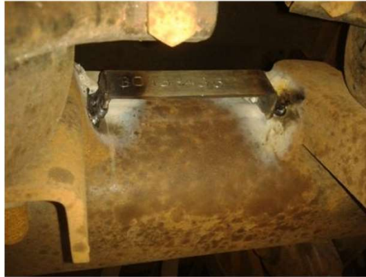
Eixo auxiliar de caminhão, usado, com duas numerações de série.
