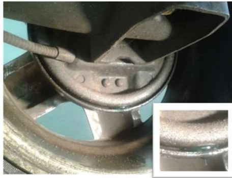
Vazamento de fluido no cilindro de roda do tambor de freio.
