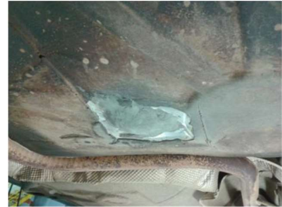
Tanque de combustível reparado com massa epoxi.
