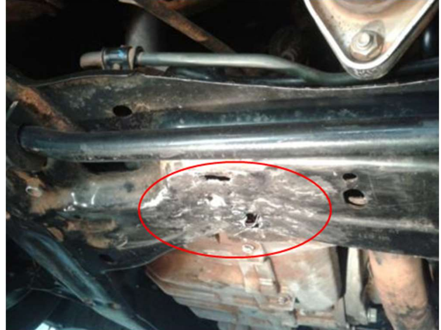
Quebra e deformação de agregado, com reparo inadequado.
